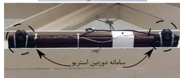
شکل ۵) سامانه حسگر موقعیت با استفاده از دوربین استریو
