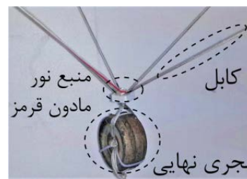
شکل ۴) سامانه طراحی شده به منظور اندازه‌گیری نیروی کابل در یک موقعیت ثابت
